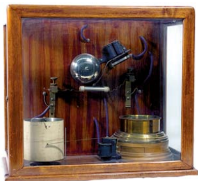
Fot. 6. Wykrywacz burz (грозоотметчик) Popowa. Wyraźnie widać rurkę koherera, dzwonek i przyrząd rejestrujący wyładowania atmosferyczne na papierowej taśmie wg [8]
