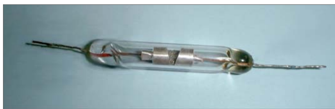
Fot. 4. Koherer, czyli najprostszy odbiornik fal elektromagnetycznych. W środku wyraźnie widoczne są opiłki metalu reagujące na składową magnetyczną fali wg [6]
