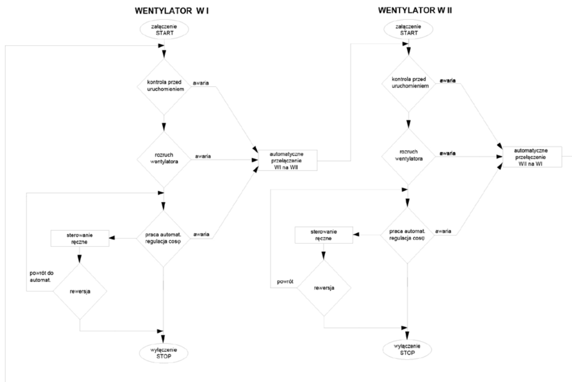
Rys. 10. Schemat blokowy algorytmu sterowania wentylatora
