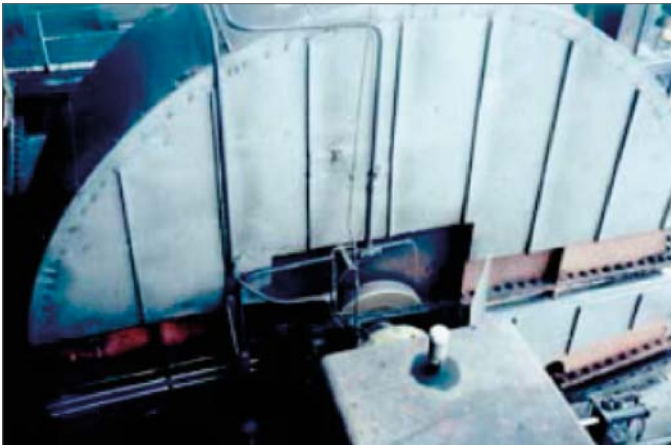
Rys. 1. Wiryk wentylatora do transportu pneumatycznego pyłu węglowego. Pojedynczy przestój serwisowy stanowi koszt około 1000 USD, co daje około 24 000 USD/rok [10]
