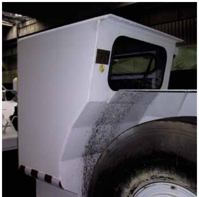
Rys. 2. Przykładowa ostona kapsułowa
