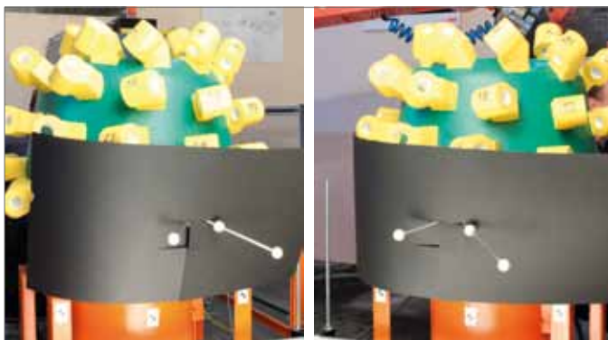
Rys. 5. Zdjęcia pomiarowe wykonane podczas pomiaru parametrów stereometrycznych uchwytu nożowego Fig. 5. The photos taken during measurement of the pick box stereometric parameters
