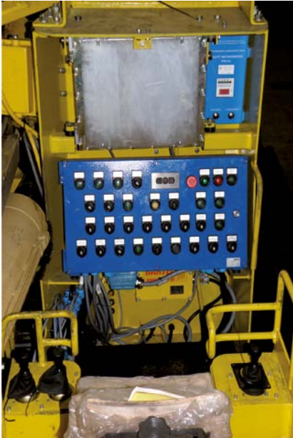
Monitor i pulpit sterowania w kabinie kombajnisty
