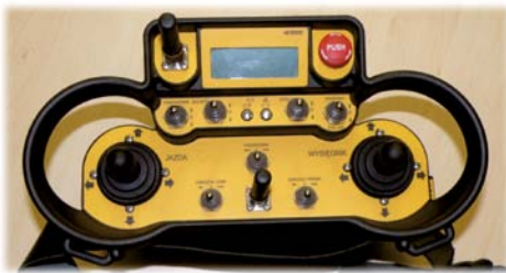
Nadajnik radiowy zdalnego sterowania funkcjami urabiania
