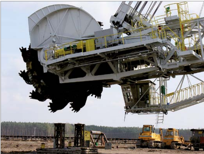
Rys. 6. Zmodernizowany mechanizm napędu koła czerpakowego koparki KWK 1500s w KWB „Konin”
