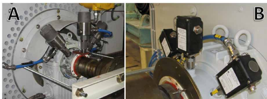
Rys. 5. Przykłady zainstalowania czujników znacznika fazy oraz czujników XY na silnikach łożyskowych ślizgowo z pomocą obudów (A) TYP 21000 oraz (B) TYP 31000/32000
