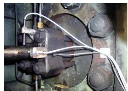
Rys. 13. Czujniki monitorowania położenia oraz dynamiki tłoczyska
