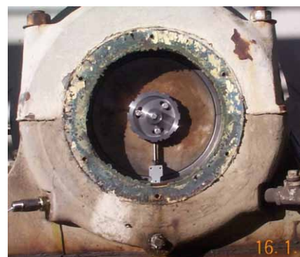
Rys. 8. Specjalne koło umożliwiające generację multiznacznika fazy
