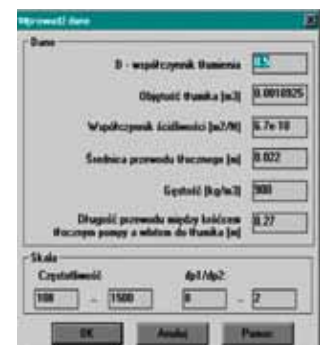
Rys. 11. Przykład okna rysującego wykres stosunków amplitud pulsacji ciśnienia przed tłumikiem \Delta p_1 i za tłumikiem \Delta p_2
