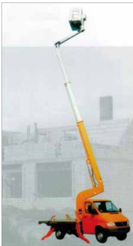
Rys. 6. Podnoszona platforma robocza, do napędu której użyto elementów mikrohydraulicznych [6]
