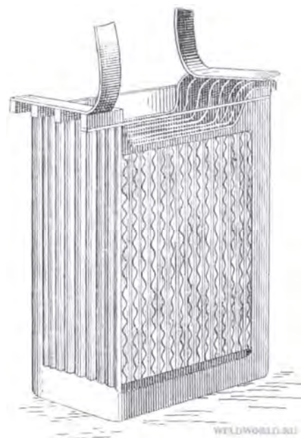
Fot. 4. Akumulator udoskonalony przez M.N. Bienardosa wg [7]
