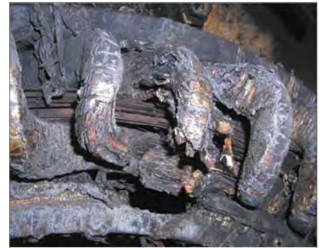
Rys. 16. Skutki zwarcia w główce cewki
