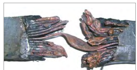
Rys. 11. Widok cewki, w której wystąpiło zwarcie zwojowe w środkowej strefie długości rdzenia stojana
