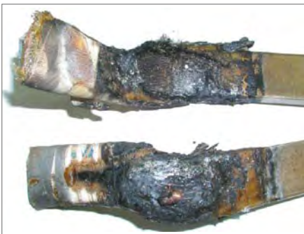
Rys. 13. Zwarcie między cewkami fazowymi w strefie wykorbienia czoł cewek
