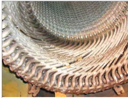
Rys. 14. Deformacja czoł po krótkotrwałym zwarceniu
