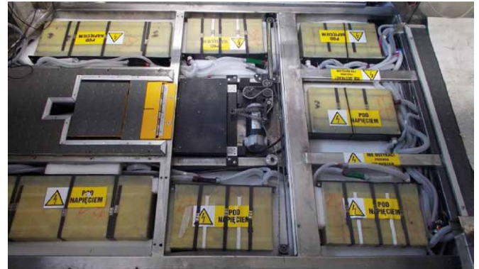
Rys. 2. Baterijny magazyn energii umieszczony w ramie podwozia pojazdu
