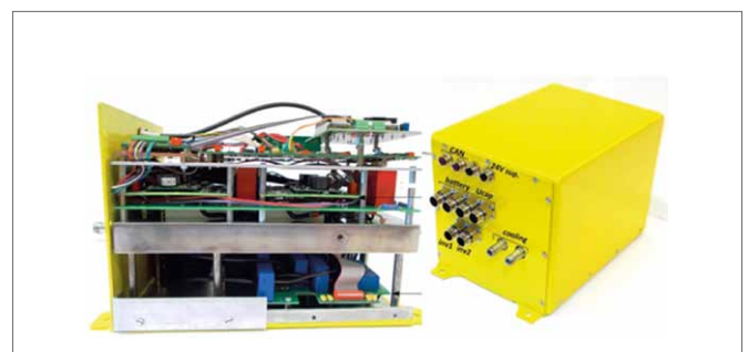
Rys. 5. Konstrukcja przekształtników napięcia stałego
