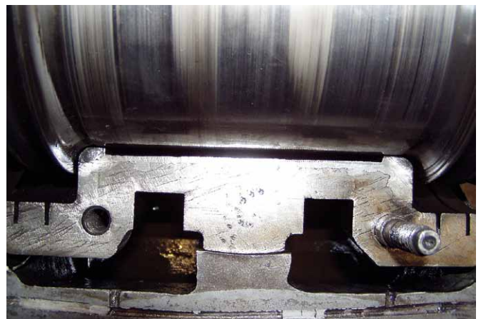
Rys. 8. Uszkodzona panewka silnika SYUe-148r/01 1000 kW 6 kV
