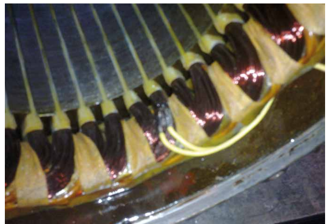
Rys. 4. Uzwojenie silnika przygotowanego do realizacji zwarcia zwojowego
