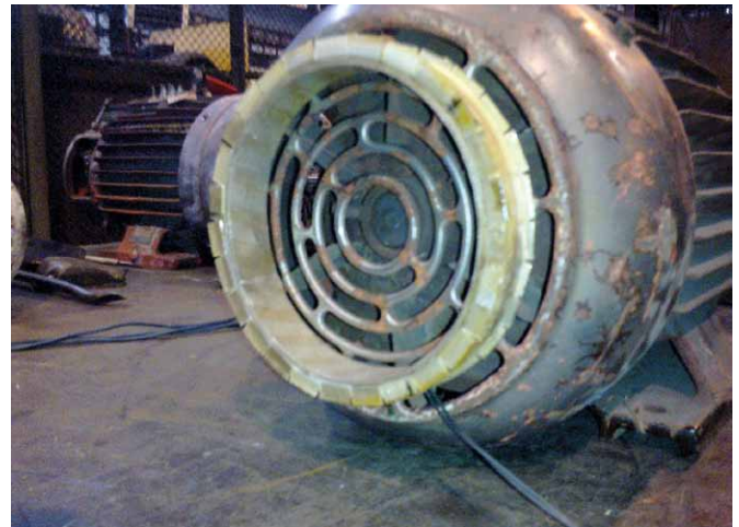
Rys. 3. Cewka zamontowana na badanym silniku
