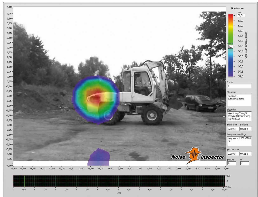
Rys. 4. Maszyna podczas pracy jałowej - strona prawa n = 1700 obr/min, odległość 10 m, zakres częstotliwości: 340–2800 Hz
