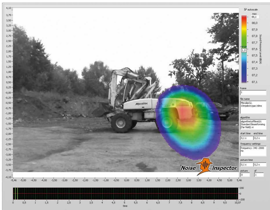
Rys. 6. Maszyna podczas pracy jałowej – strona lewa n = 2150 obr/min, odległość 10 m, zakres częstotliwości: 340–2800 Hz
