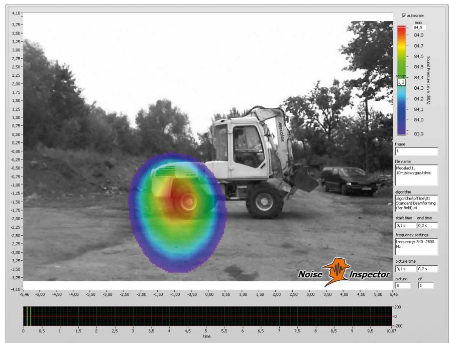
Rys. 5. Maszyna podczas pracy jałowej - strona prawa n = 2150 obr/min, odległość 10 m, zakres częstotliwości: 340–2800 Hz
