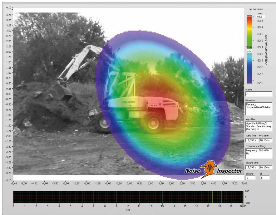
Rys. 8. Maszyna podczas kopania – strona lewa odległość 10 m, zakres częstotliwości: 500–850 Hz
