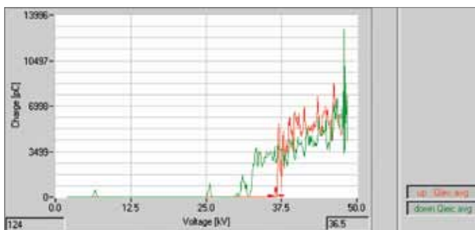
Rys. 5. Krzywa qV pręta z wadą typu kawerna – kolejne najazdy napięcia
