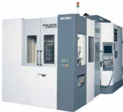
Rys. 4. Centrum obróbkowe Okuma 400 HA do obróbki analizowanego korpusu [1, 10]
