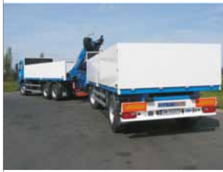
Rys. 4. Zestawy budowlane specjalistyczne DBV z żurawiem na tylnym zwisie
