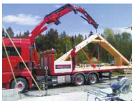
Rys. 5. Zabudowy budowlane specjalistyczne Z4 z montowanym żurawiem na tylnym zwisie lub za kabiną pojazdu
