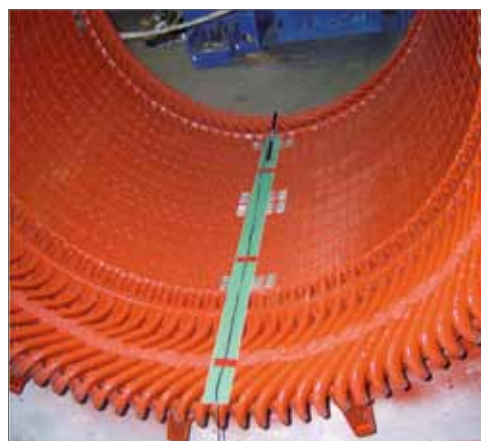
Rys. 13. Prototypowa antena paskowa własnej konstrukcji w czasie pomiarów off-line wnz stojana
