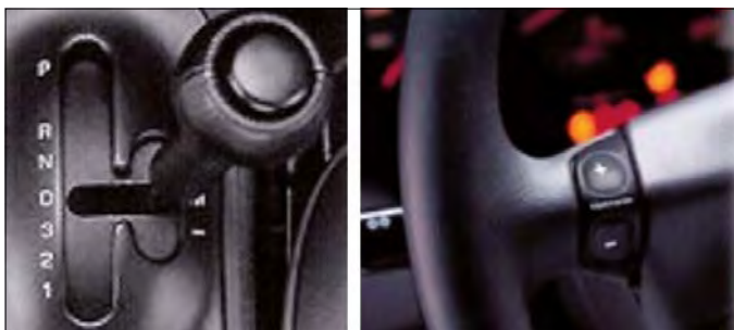
Rys. 11. Elementy sterujące systemem Tiptronic na obudowie selektora oraz na kierownicy [3]
