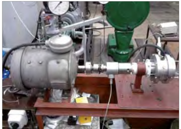
Fot. 12. Widok urządzenia z napędem poprzez momentomierz do badań laboratoryjnych uszczelnień czołowych z pierścieniem elastoplastycznym
