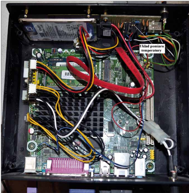
Rys. 4. Rejestrator temperatury zbudowany w oparciu o płytę główną miniPC z zaznaczonym układem pomiaru temperatur
