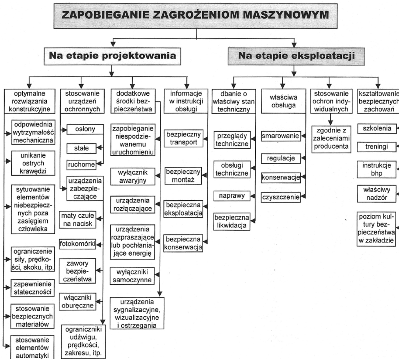
Rys. 3. Wybrane sposoby zapobiegania zagrożeniom maszynowym [29, 40]
