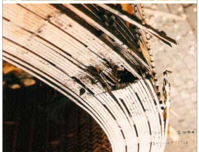
Rys. 5. Miejsce zwarcia uzwojenia fazy „B”
