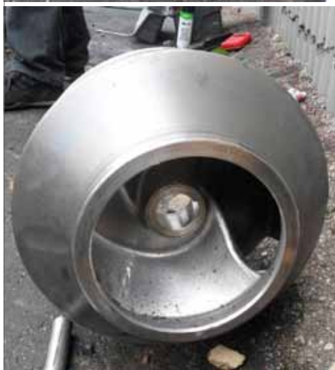
Rys. 14. Wirnik zamknięty dwukanałowy o średnicy 355 mm pompy o mocy 75 kW
