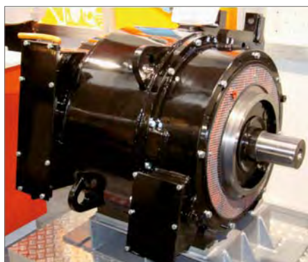
Fot. 3. Silnik indukcyjny STx 500-4A, 830 kW do napędu lokomotywy
