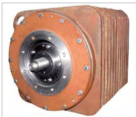
Fot. 4. Silnik wzbudzany magnesami trwałymi z komutacją elektroniczną do napędu lokomotywy kopalnianej o mocy 60 kW
