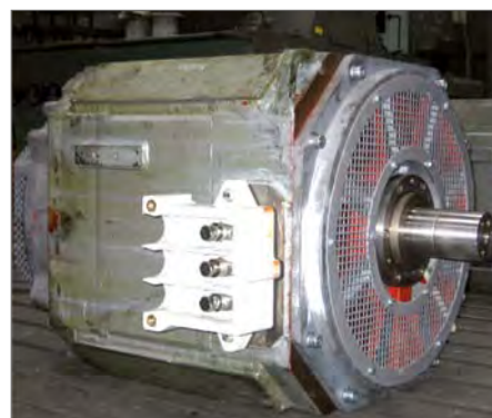
Fot. 5. Silnik STDa280-4B, 180 kW do napędu metra warszawskiego
