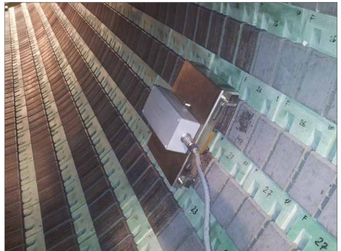
Rys. 3. Głowica pomiarowa z uchwytem magnetycznym podczas pomiarów
