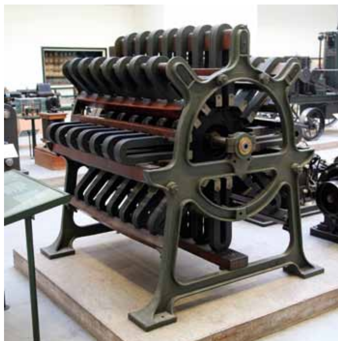
Magneszy w magnetoelektrycznym silniku z 1863 roku firmy Alliance
