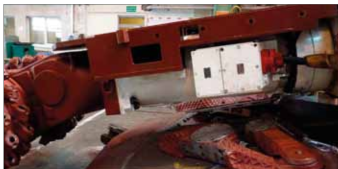
Rys. 4. Silnik dwuklatkowy zamontowany w ramieniu kombajnu
