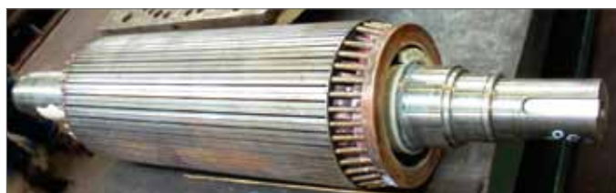
Rys. 5. Uzwojenie klatki rozruchowej wirnika silnika do napędu kombajnu
