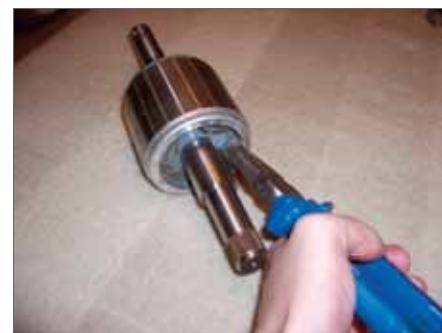
Rys. 9. Proces osadzania magnesów trwałych w wirniku
