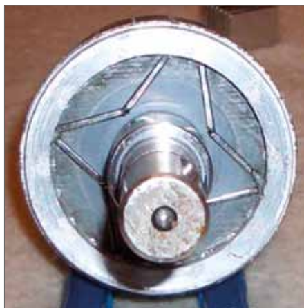
Rys. 6. Wirnik silnika prototypowego wzbudzanego magnesami trwałymi
