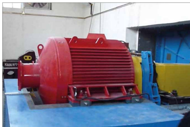
Rys. 8. Widok silnika o mocy P = 1100 kW na stanowisku pracy
