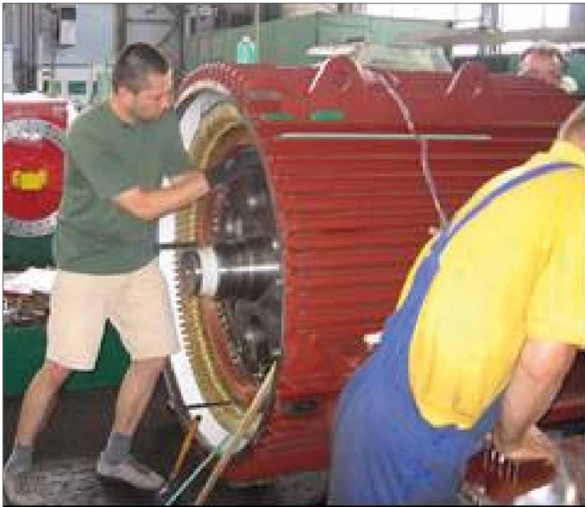
Rys. 7. Montaż magnesów w silniku o mocy znamionowej P = 1100 kW
