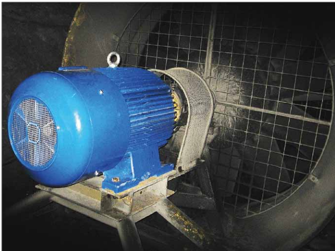
Rys. 2. Silnik synchroniczny z magnesami trwałymi o mocy znamionowej 110 kW
