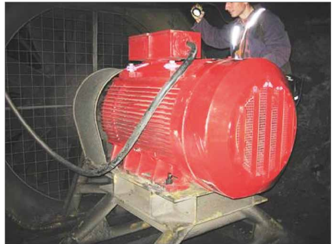
Rys. 4. Silnik synchroniczny z magnesami trwałymi z wentylatorem typu WOO 200B
