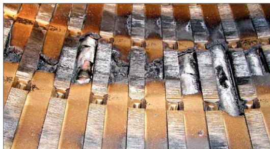
Rys. 10. Wypalone kliny żłobkowe w wyniku zwarc do rdzenia stojana i zwarc zwojowych
