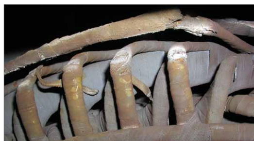
Rys. 9. Wzajemne wytarcie izolacji na połączeniach międzycewkowych i zasilających
