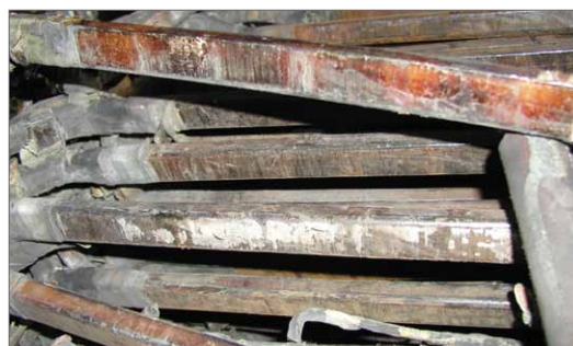
Rys. 8. Wytarcia izolacji głównej w żłobkach oostre blachy rdzenia stojana
