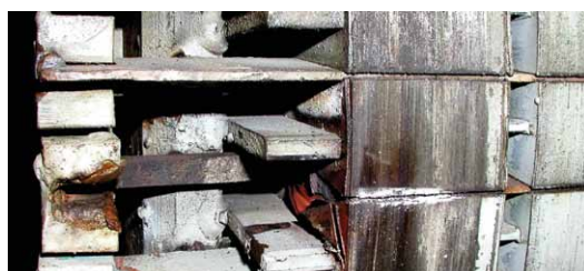
Rys. 20. Uszkodzenie wirnika jednoklatkowego
