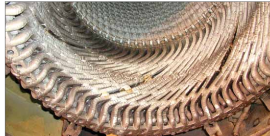
Rys. 13. Widok nieznaczących deformacji czoł
