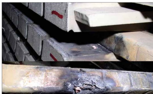
Rys. 11. Zwarcie cewki uzwojenia do rdzenia na wyjściu ze żłobka stojana
