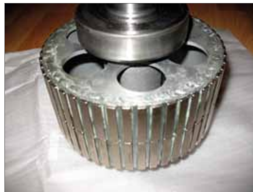
Fot. 2. Wirnik prądnicy z naklejonymi magnesami
