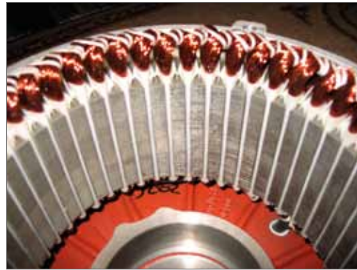
Fot. 1. Uzwojony stojan prądnicy – widoczne proste żłobki
