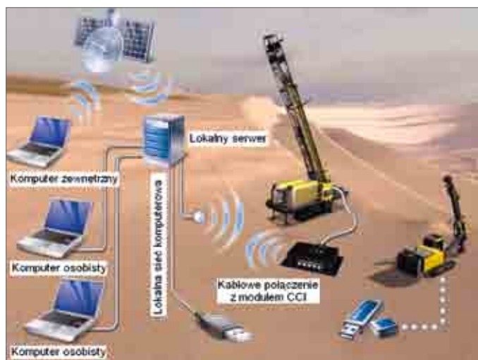
Rys. 4. System zarządzania i sterowania maszynami wiertniczymi z wykorzystaniem Internetu. Wiertnice pracują w trybie autonomicznym [5]
