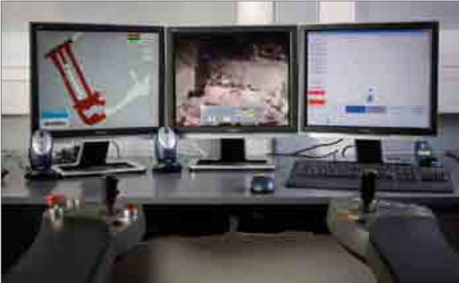
Rys. 2. Sterowanie i nawigowanie pracą ładowarki z użyciem kamer i monitorów [16]
