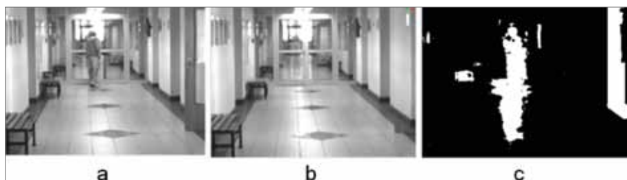
Rys. 11. Przykład automatycznego wykrywania intruza i podłożonej bomby
