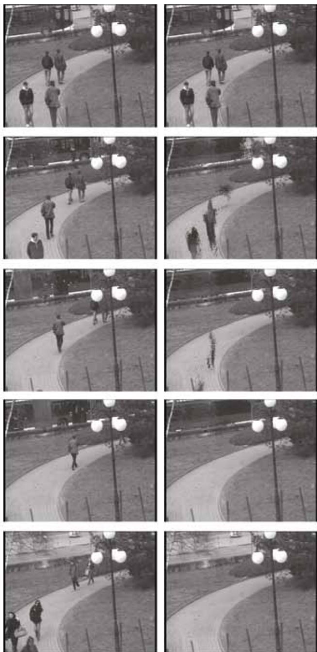
Rys. 12. Rezultaty generacji tła metodą uśredniania obrazów z wielu klatek. Po lewej pokazana jest aktualna klatka, po prawej rekonstruowane obliczeniowo tło. Wyniki przedstawiono dla klatek o numerach 1, 50, 100, 150 i 800
