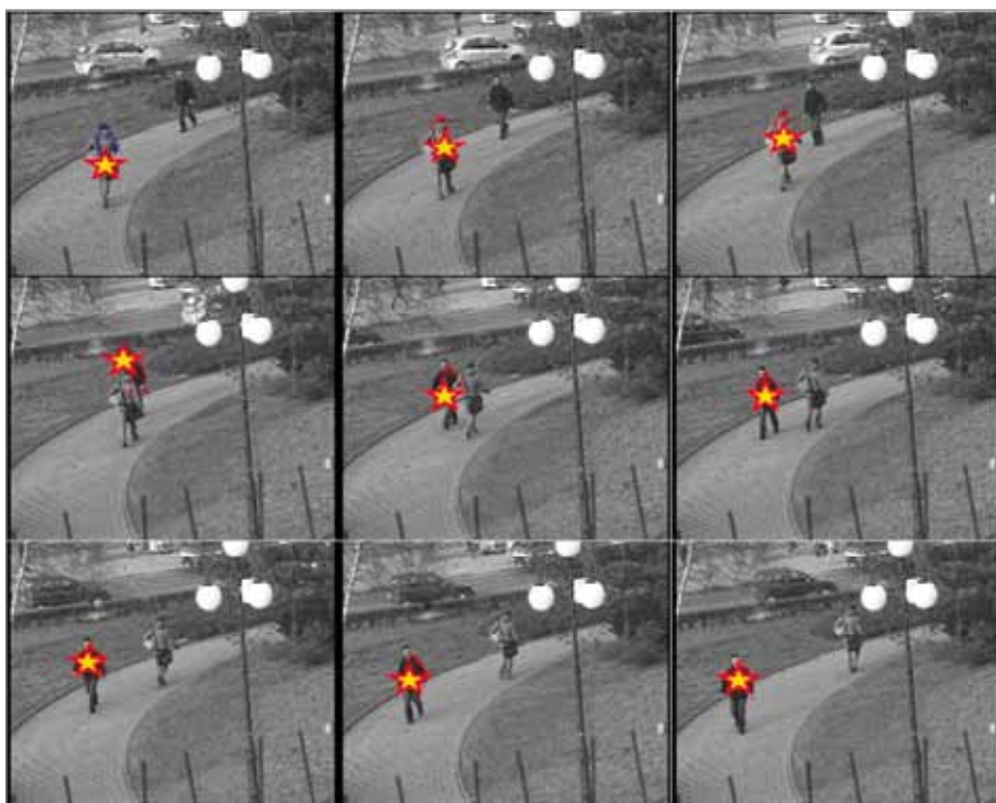
Rys. 16. Przykład błędu powstającego podczas automatycznego śledzenia ruchu ludzi
