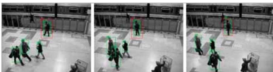
Rys. 17. Przykład bezbłędnego równoczesnego śledzenia automatycznego wielu osób
