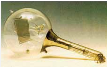
Fot. 6. Wygląd zewnętrzny ikonoskopu, wg [9]
