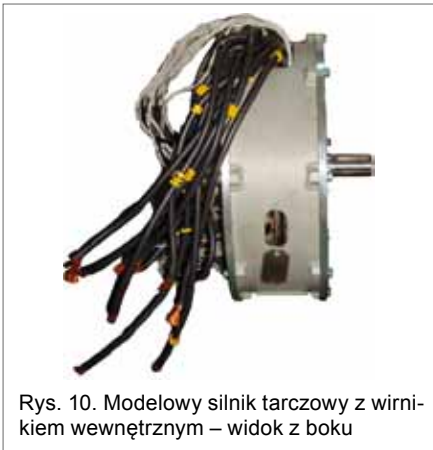
Rys. 9. Modelowy silnik tarczowy z wirnikiem wewnętrznym – widok z przodu
