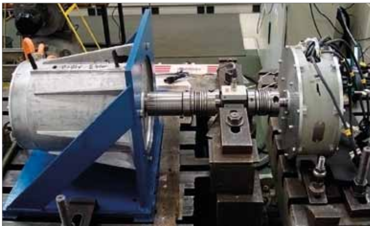
Rys. 13. Silnik tarczowy z wirnikiem wewnętrznym na stanowisku badawczym
