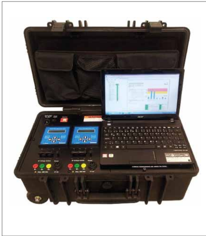
Rys. 15. Zestaw przenośny do rozpoznawania anomalii agregatów napędzanych SE
