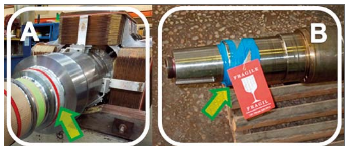
Rys. 14. Przykładowe zabezpieczenie ścieżek pomiarowych wałów dwóch silników
