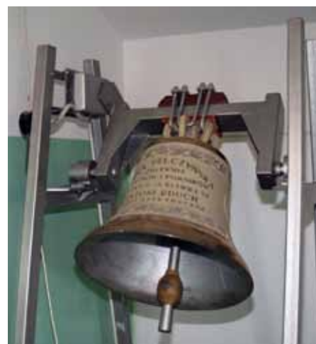
Napęd dzwonu silnikiem liniowym
