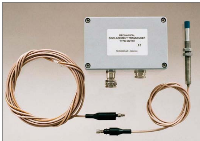
Rys. 5. Bezdotykowy układ pomiarowy MDS10/MDT10 [15]
