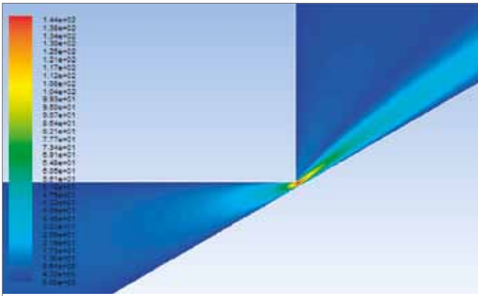
Rys. 5. Rozkład prędkości dla przemieszczenia z = 20 \mu\text{m} oraz natężenia przepływu 0,4 \text{ l/min} w powiększeniu (liczba Reynoldsa 72,1; spadek ciśnienia 11,5 \text{ MPa} )
