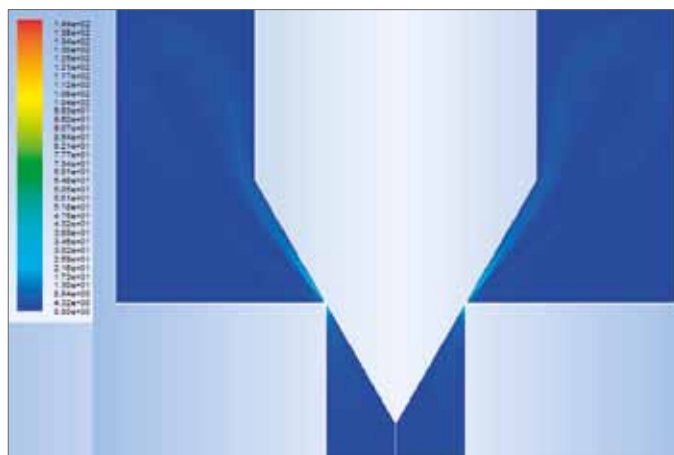
Rys. 4. Przykładowy rozkład prędkości cieczy dla przemieszczenia z = 20 \mu\text{m} oraz natężenia przepływu 0,4 l/min
